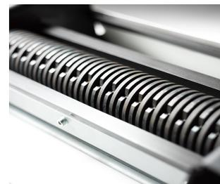
Le matériau d'emballage peut être fabriqué sur mesure en ajustant librement la largeur de travail avec l'échelle graduée.
